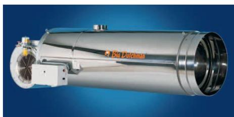
RGAヒーティングデバイスは燃料オイルで可動します。これらは閉ざされた室内で燃焼し可動します。つまり室内には燃焼ガスと汚染されたガスが残されます。しかし新鮮な空気は外から吸い込まれ、燃焼された空気は室内からチムニー換気によって排出されます。
