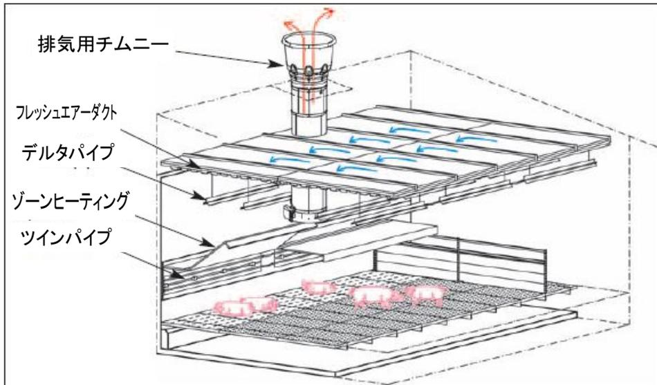
ゾーンヒーティングと全体的なヒーティングを合わせて温度を保つことが理想的です。その結果、室内は豚の発育にあわせた理想的な温度で保つことができます。右図は、入ってくる空気を温めるデルタパイプと、それに結合したフレッシュエアダクトシステム(全体暖房)と、特に温度が必要な子豚休息エリアだけを温めるゾーンヒーティングの図解です。
